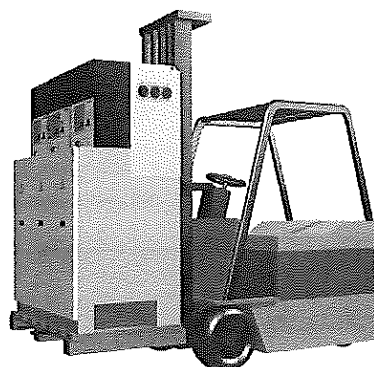
Фигура 2.4: Повдигане с мотокар на шкаф CGMCOSMOS
